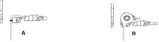
ISG-Griffleiste ca. 8cm nach unten ziehen und Rasthilfe, wie in **Bild B** gezeigt in die Abrollleiste einhängen. Von einer Kastenseite ausgehend nach unten ziehen. Rasthilfe nicht aushängen sondern in der Nut weiter schieben. Vorgang wiederholen bis der Kasten komplett aufgerastet ist.
